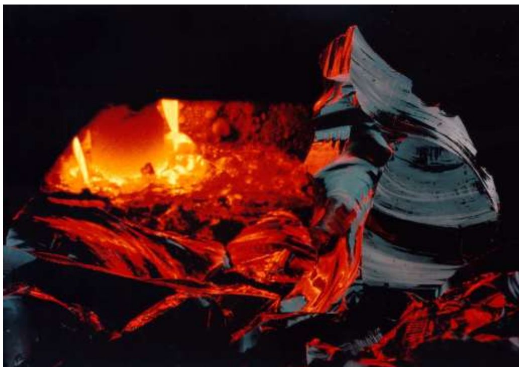
Figur B4. Så här kan det se ut när en anläggning för tillverkning av kärnavfallsglas är i drift.
